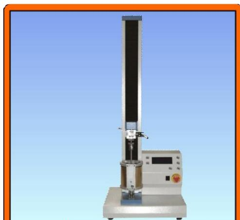
**Ball Burst Testgerät**
